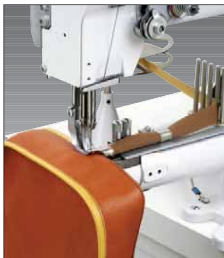
Швейная оснастка E4 и шагающий окантователь №14 для окантовки края
